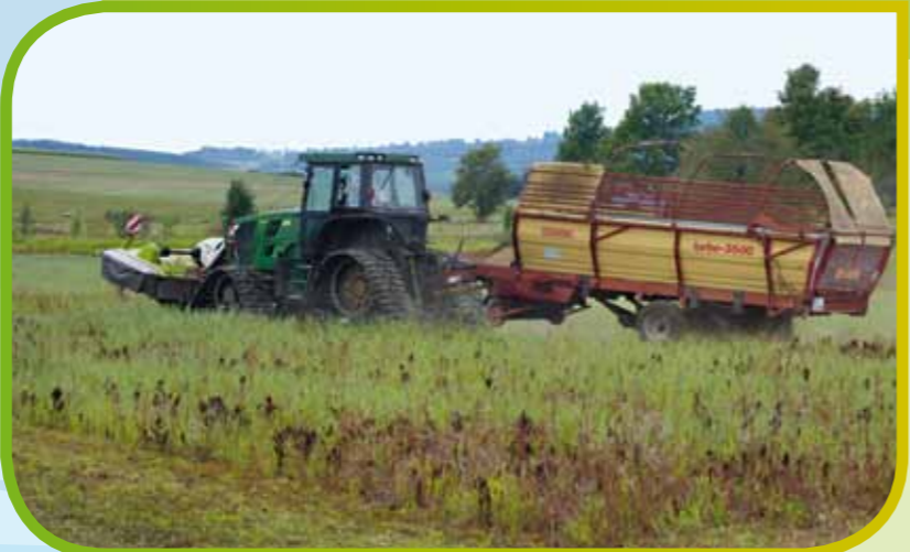
Vegetationsentnahme mit speziell auf den feuchten Teichboden angepasstem Gerät
